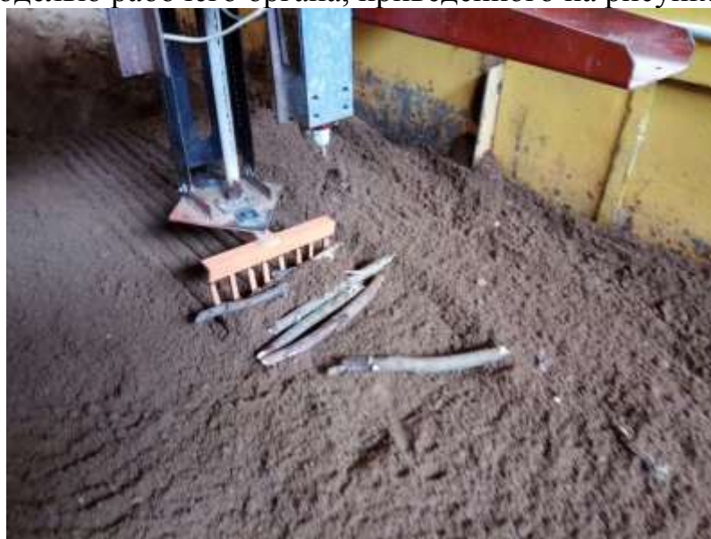
Рисунок 2 - Процесс корчевания рабочим органом кустарниковых граблей древесно-кустарниковой растительности при большой залесенности местности.
